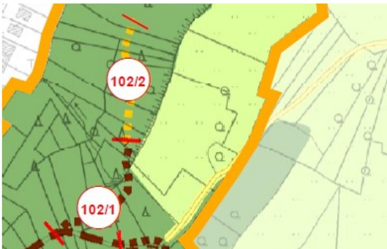
Die Planung des Wegeabschnittes 102/1 quert einen Siefenkopf in steilem Gelände. Für den Wegebau sind aufgrund der Steilheit entsprechend große Erdbewegungen mit ausgeprägten Böschungen erforderlich. Zudem besteht die Sorge, dass durch die Herstellung des Weges oberhalb des Quellbereiches, die Wasser-
